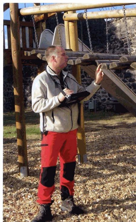
Bei der Sichtprüfung der Spielgeräte werden alle relevanten Daten mithilfe einer Kontroll-Checkliste am Tablett-PC schnell und rechtssicher erfasst.
