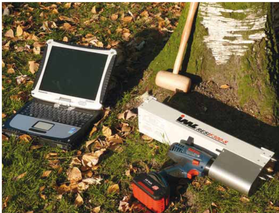
Das Equipment für die eingehende Baumuntersuchung besteht aus Outdoor-Laptop (Panasonic) mit Punch-byte-Kontrollsoftware, Schonhammer und Resistographen (IML).
