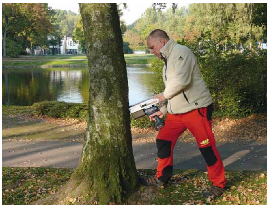
Jochen Grüber setzt den Resistographen ein. Mit einer feinen Nadel werden Höhlungen, Restwandstärken etc. exakt gemessen und....
